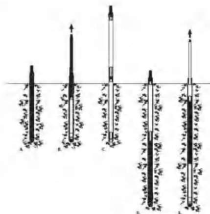
图 3.2.1-1 土壤钻探取样示意图
