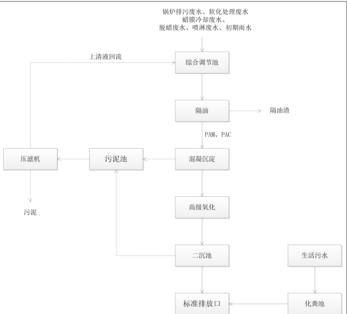
图 4-2 项目废水处理工艺流程图
