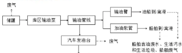
图4-2 油品装船/装车作业工艺流程示意图
