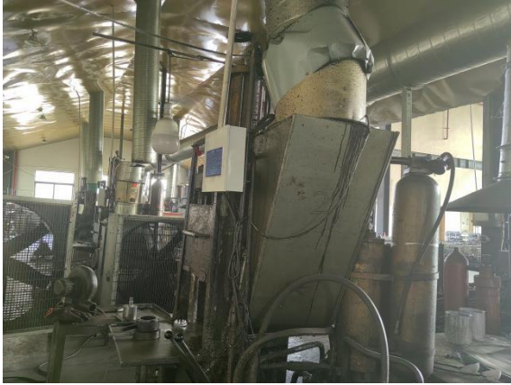
压铸脱模废气经集气罩收集
