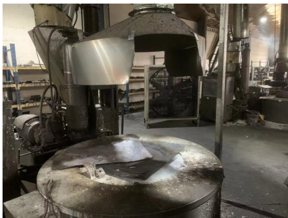
熔化炉上方设置两面围挡及集气罩
