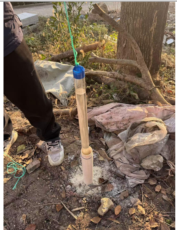
D004 地下水贝勒管取样
