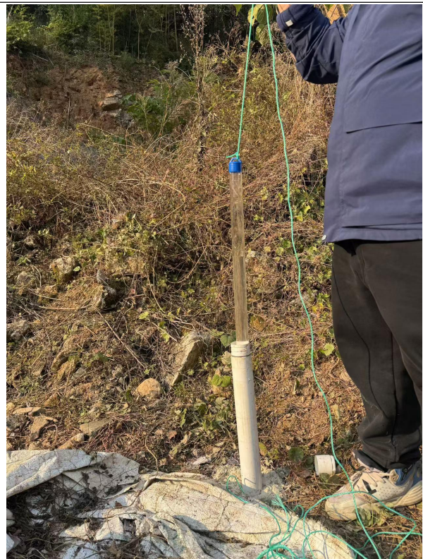
D002 地下水贝勒管取样
