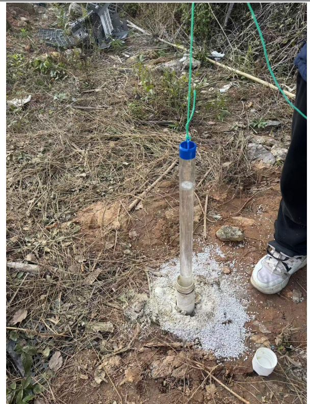
D003 地下水贝勒管取样
