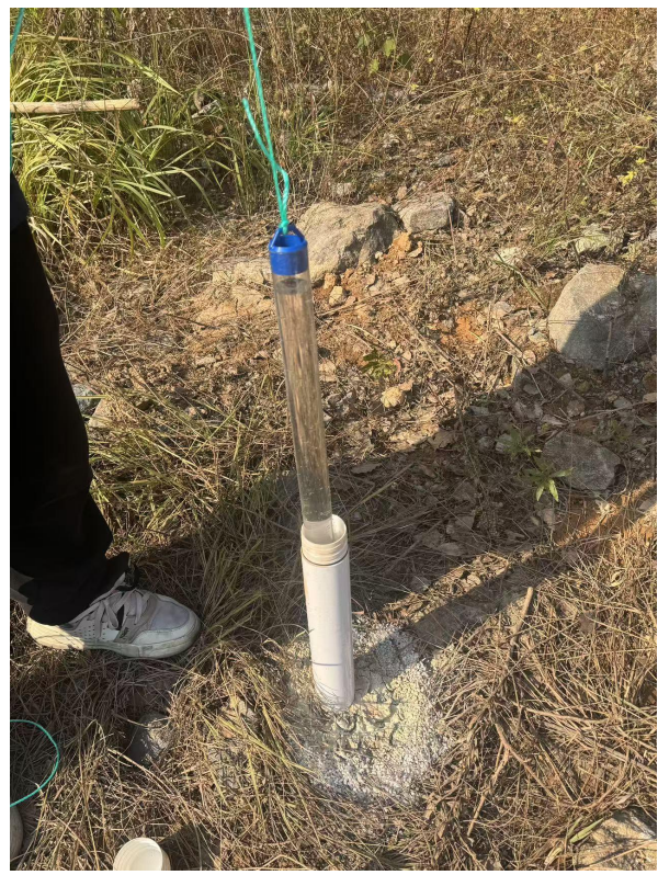
D001 地下水贝勒管取样
