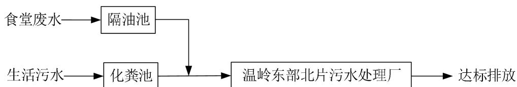
图 3-1 项目废水处理工艺流程图
