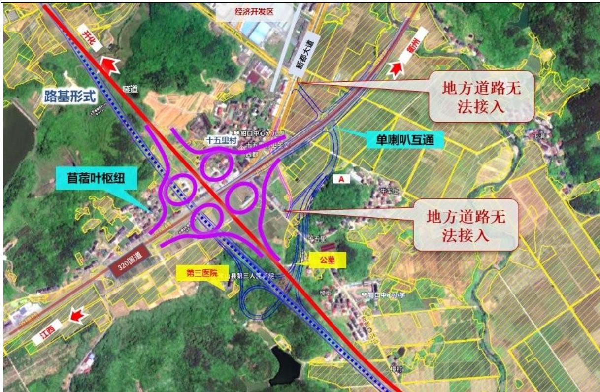
图 3-32 若考虑采用首蓆叶枢纽互通方案示意平面
