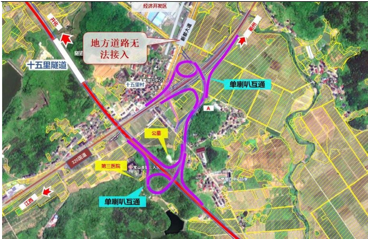
图 3-33 若考虑采用双喇叭互通方案示意平面
