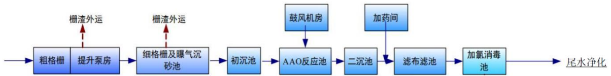
图 5-12 温岭东部北片污水处理厂（现状实际）污水处理工艺流程图
