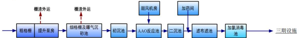
图 5-12 温岭东部北片污水处理厂（现状实际）污水处理工艺流程图
